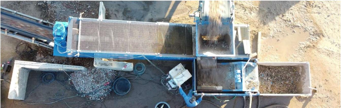
Der stufenlos regelbare Propeller erzeugt einen Aufstrom in der Trennkammer und transportiert die Leichtstoffe auf die Austragseinheit. Die Schwerstoffe sinken in der Trennkammer zu Boden und werden mittels Schneckenförderer ausgetragen. Um ein Fördern und Waschen mit der Schnecke realisieren zu können, ist die Welle wechselweise mit Transportwindungen und Waschpaddel bestückt. Für einen sicheren Betrieb, sollte die Korngröße des Aufgabematerials 65 mm nicht überschreiten.
