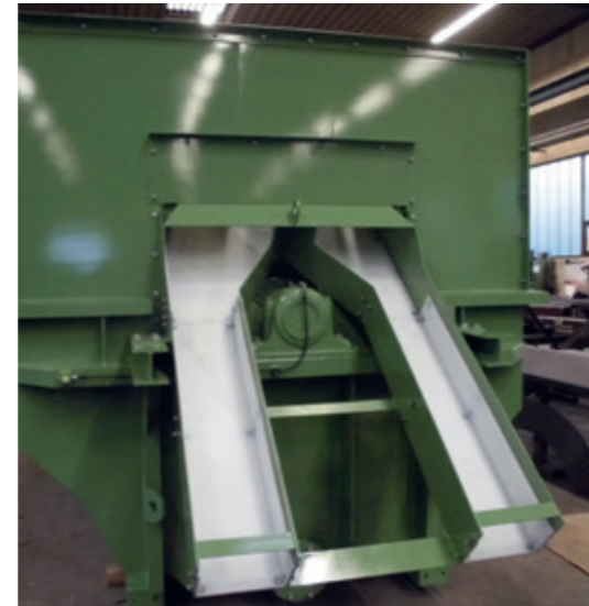
Sandfang mit Rutsche
