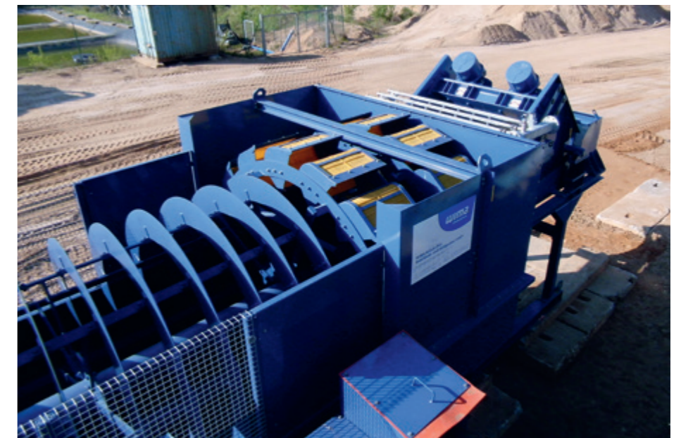
Sandfang mit doppeltem Becherkreis und Entwässerungssiebmaschine
