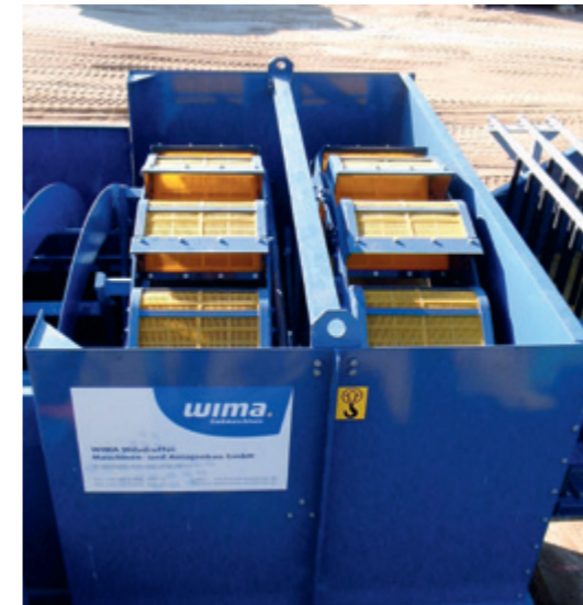
DES-Variante mit Waschkreis, Becherkreis und Entwässerungssiebmaschine
