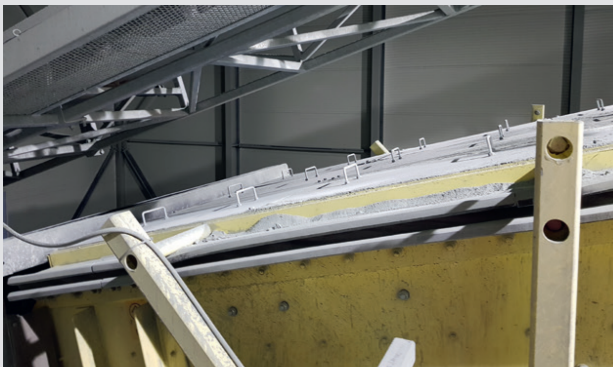
Staubschutz mit abnehmbaren Deckeln
