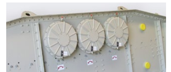
Dreifachlagerung eines Ellipsenschwingers
