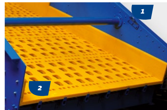
Siebkasten eines Eindecker-Plansiebes mit der Größe 2.700 x 7.000 x 1
