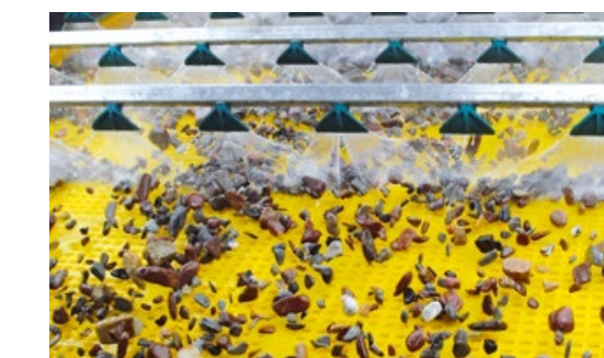
Das Siebgut staut sich etwas vor dem Wasserstrahl der Flachstrahldüse und wird somit vollständig gereinigt.
